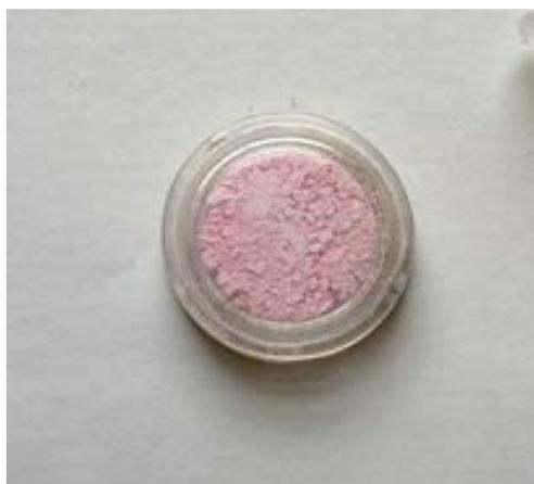
Рисунок 3. Мишень из естественной смеси изотопов эрбия
