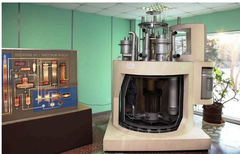
*Рис. 6. Макет реактора БН-600 с вырезанными секторами для удобства обзора*
