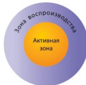
Рис. 4. Принципиальная схема активной зоны реактора БН-600.
