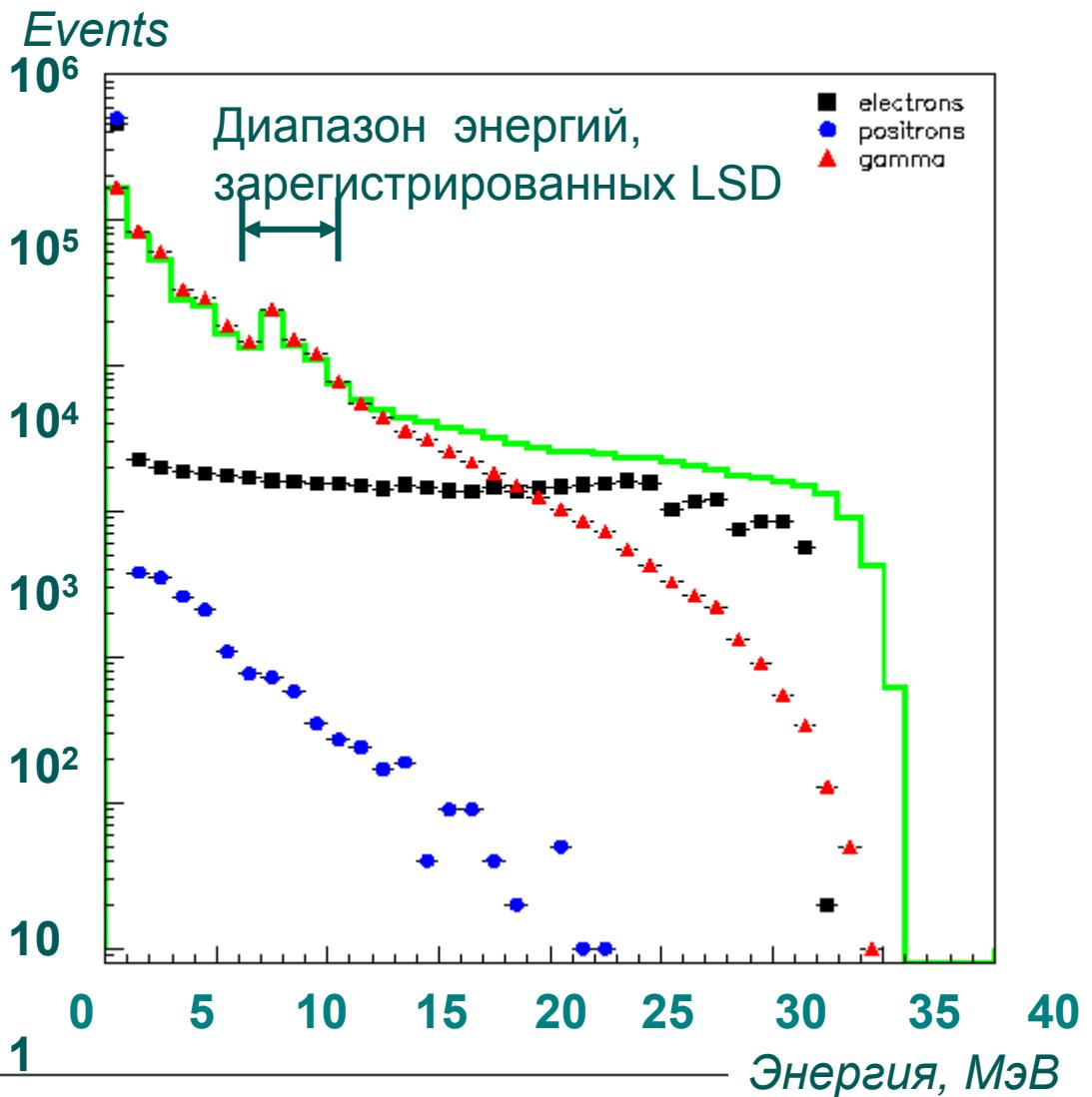
**Энергетический спектр частиц, выходящих из железной пластиинки толщиной 2,8 см**
