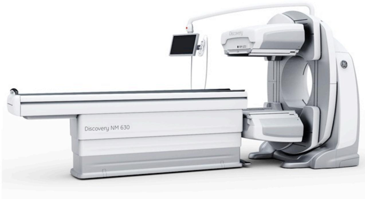
**ОФЭКТ** состоит из двух подвижных блоков. Первый блок – детектирующая система, которая состоит из одной, двух, трех или более гамма-камер, которые вращаются вокруг пациента для получения томографического изображения. Второй блок – стол, перемещающийся в горизонтальной плоскости. Детекторы могут менять взаимное расположение для удобства снятия информации разных локализаций объекта.
