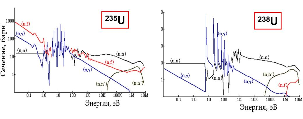
При взаимодействии нейтрона с тяжелым ядром возможен радиационный захват нейтрона — реакция  $(n, \gamma)$ . Этот процесс будет конкурировать с делением и следовательно, уменьшать коэффициент размножения. Вероятность деления для моноэнергетических нейтронов определяется соотношением
