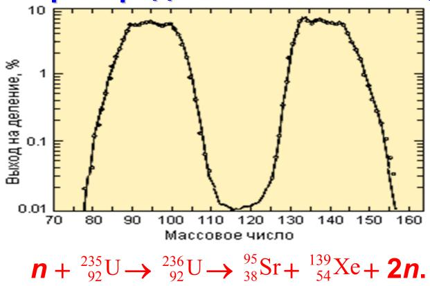
Осколки деления образуются в широком диапазоне A = 72–161 и Z = 30–65. Асимметричное деление объясняется оболочечной структурой ядра. Ядро стремится разделиться так, чтобы основная часть нуклонов каждого осколка образовала устойчивые ядра близкие к магическому остову.
