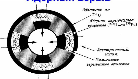
Для осуществления ядерного взрыва в результате цепной реакции деления необходимо, чтобы масса делящегося вещества (урана-235, плутония-239 и др.) превышала критическую (50 кг для <sup>235</sup>U и 11 кг для <sup>239</sup>Pu). До взрыва система должна быть подкритической. Ядерный взрыв развивается за счёт экспоненциально растущего со временем числа разделившихся ядер:
