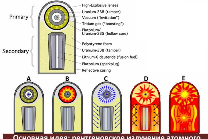
Основная идея: рентгеновское излучение атомного взрыва опережает ударную волну деления и успевает вызвать синтез до того, как вся система разлетится
