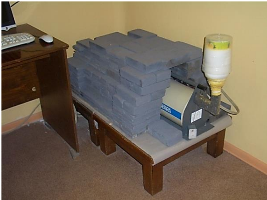
Детектор \gamma -квантов HPGe из сверхчистого германия Canberra GC3019 объёмом 130 \text{ см}^3 и эффективностью 30%. Расположен в 30 м от ускорителя RTM-70.
